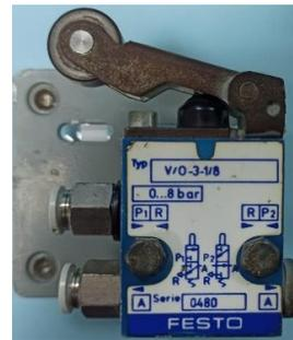
Válvula de palanca de rodillo
